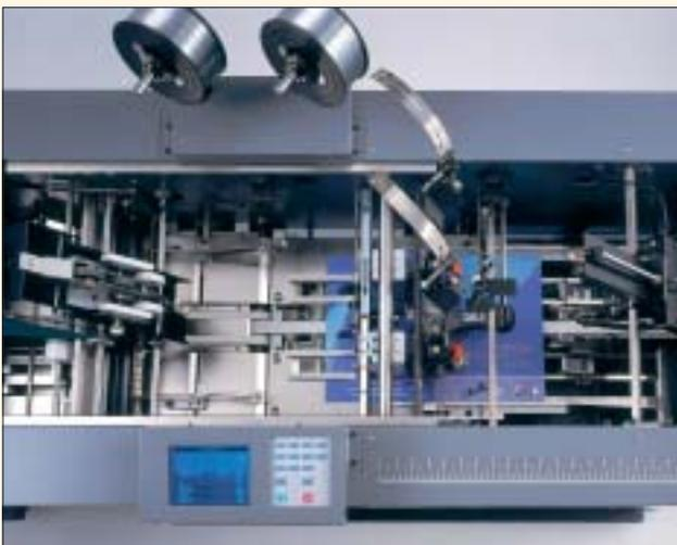
Kleinformatige Auflagen („Bonsais“) können z.B. ohne Ergänzung oder Änderung an den Maschinenaggregaten durchgeführt werden. Optimierte „wire-finished“ Sensoren garantieren perfekte Kontrolle während einer Auflage. Der nunmehr auf 70 mm reduzierte Abstand zwischen den „Stitching Heads“ garantiert eine exzellente Qualität (Bild oben).
